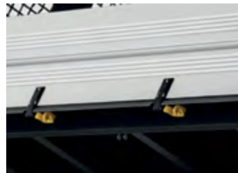
drážka v bočnici a háky pod privesom pre uchytenie plachty či fixačných pásov
