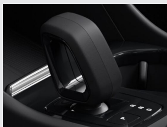
čalúnená hlavica radiacej páky, bez použitia kože
